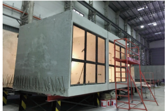
Một module PPVC đang được chế tạo bên ngoài trước khi đưa vào lắp đặt tại công trường cho chung cư 40 tầng Clement Canopy. Đây là tòa nhà PPVC bê tông cao nhất thế giới khi hoàn thành vào năm 2019
