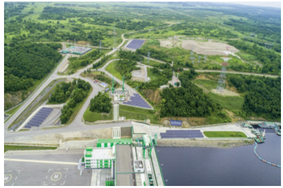
Nhà máy thủy điện Nizhne Bureiskaya là dự án đầu tiên theo mô hình lai phát - thủy điện kết hợp điện mặt trời
