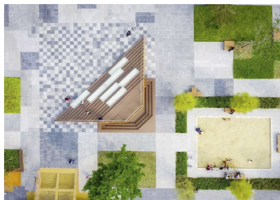
Quảng trường Vanke Cloud City (Trung Quốc) với vật liệu bề mặt là sự đá tự nhiên xen kẽ bê tông nhằm làm mát bề mặt và giảm chi phí xây dựng.
