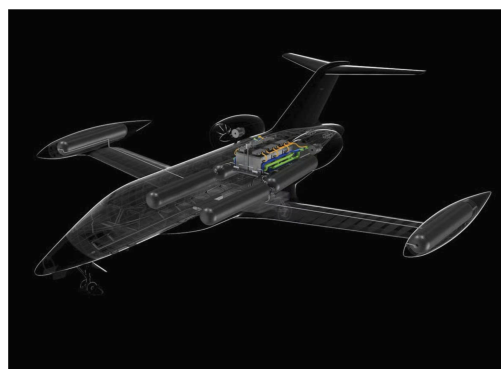
Các bình chứa hydro được bố trí dọc theo thân máy bay và ở phần đỉnh cánh, cung cấp năng lượng cho hai động cơ phản lực điện.
