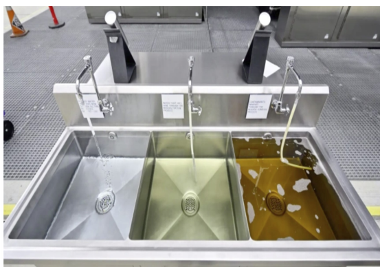
Mô hình xử lý nước thải được xử lý theo ba cấp độ tại quận Cam (California), từ phải sang trái: Thẩm thấu ngược, lọc cho hệ thống tái chế, lọc vi mô thẩm thấu ngược sau đó lọc qua tia cực tím.
