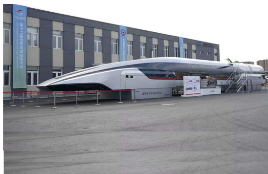
Mẫu tàu đệm từ cao tốc siêu dẫn có tốc độ thiết kế 600 km/h tại Triển lãm quốc tế về công nghệ và thiết bị đường sắt hiện đại lần thứ 17, diễn ra tại Trung Quốc.
