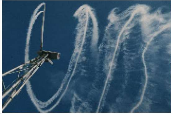
Hình 4-7. Đường rẽ nước được minh họa bằng khói.
