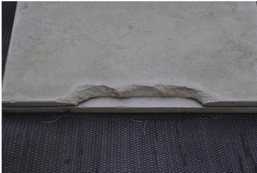
Hình 1.28 - Cạnh của tấm đá sau khi được thử nghiệm với một neo đơn [1]
