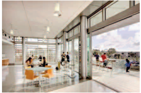
Quán cà phê Consortium for Regenerative Medicine có tường kính trượt, có thể tận dụng gió biển, đồng thời các thiết bị che nắng kết hợp với hệ thống thông gió và hệ thống HVAC bức xạ để tăng hiệu quả năng lượng.
